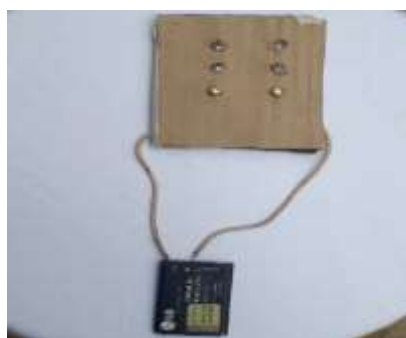
Figura 2 – Painel de LED's ligado aos terminais elétricos da bateria de celular.
