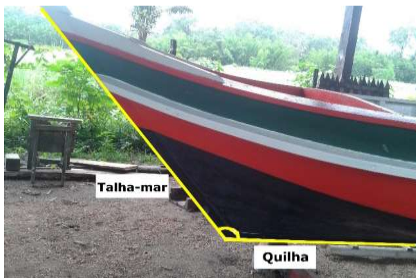
Imagem 2 - Ângulo formado pelos segmentos do Talha-mar e Quilha
